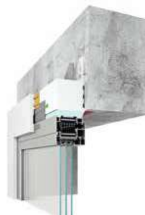
verbinding boven, met toepassing van een bovenstijlprofiel
