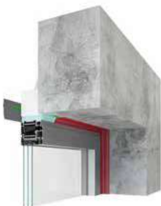
verbinding boven, met dampdicht band en lijm-afdichting
