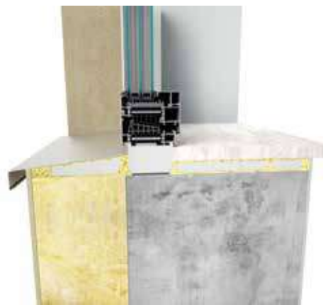
dwarsdoorsnede van raam dat is gemonteerd in het muurvlak
